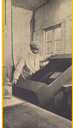
9 Protección con sangre de drago de las paredes de la plancha
